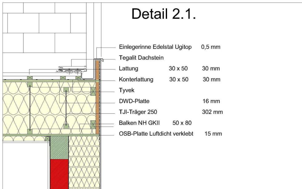
BV Motschenbacher: Neubau eines EFH mit Carport und Garage im Passivhausstandard. Detail 2.1. Ortgang M 1:10 04.03.2005 gez. AM 2004-038-257 A
