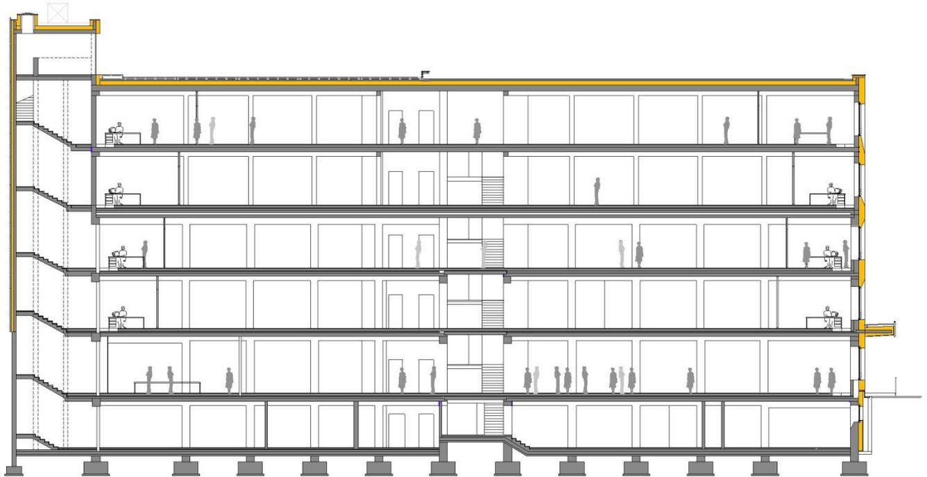
**Längsschnitt durch das Passivhaus Expost – Landhaus 11, gelb eingezeichnet thermische Hülle inklusive dem Stiegenhaus.**
