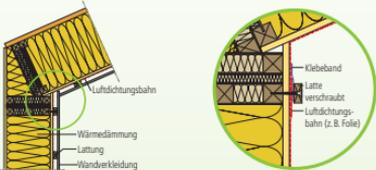
Beispiel: Luftdichter Anschlusspunkt Holzbau Dach/Außenwand
